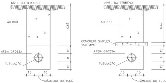
Detalhe Tubulação Enterrada SEM ESCALA
